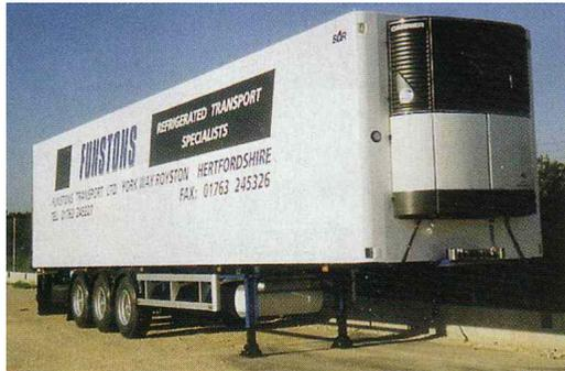
**Auflieger mit Kühlaggregat für den Transport temperatur-empfindlicher Güter**
